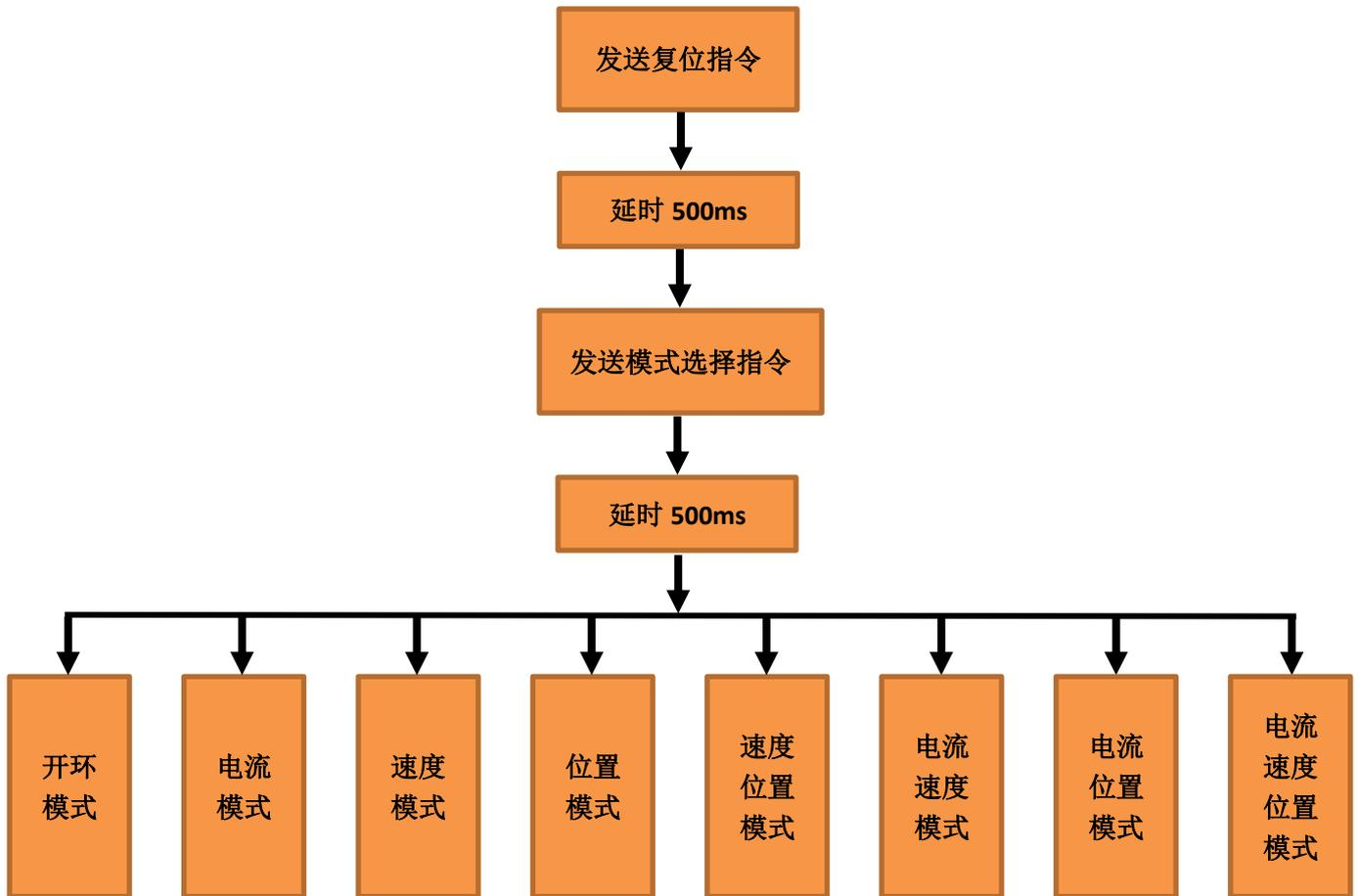
使用 CAN 的通信方式来控制驱动器，控制流程如下：
