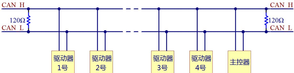
RMDS 系列的所有驱动器的内部都没有焊接上  $120\Omega$  的电阻。所以用户需要多个驱动器一起使用 CAN 总线的时候,请在起点和末尾分别补上  $120\Omega$  的电阻,直接跨接在 CANH 和 CANL 的外接端口上即可。
