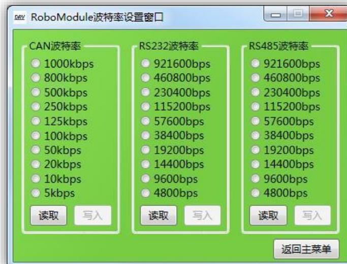
出厂默认的 CAN 的波特率为 1000kbps。如需改变，请直接在<RoboModule 直流伺服电机驱动器调试软件>上操作修改即可。
